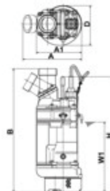
W1: Niveau minimum de pompage
