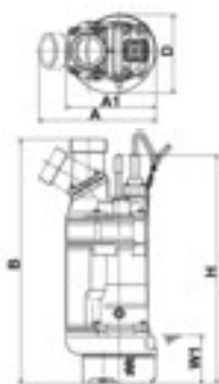
W1: Niveau minimum de pompage
